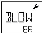
При достижении срока технического обслуживания устройства после начальной индикации появляется индикация "BLOWER" ("НАГРЕВАТЕЛЬ") или "DRIVE" ("ПРИВОД"). Эта индикация автоматически исчезает через 10 секунд, или ее можно выключить, нажав кнопку *подтверждения* (40). Устройство необходимо доставить в сервисный центр.
