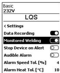
При включении функции Monitored Welding (Постоянный контроль сварки) регистрируются предельные значения записанных параметров сварки. Выберите пункт меню Monitored Welding, нажав кнопку «Минус» (32). Затем нажмите кнопку «Подтвердить» (33).
