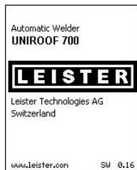
После запуска на дисплее кратковременно появляется **стартовый экран** с номером текущей версии программного обеспечения и обозначением устройства.
