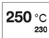
Если включена функция Set Values (Установить значения) (заводская настройка), на рабочем дисплее (41) отображаются фактическая температура (высокая) и заданная температура (низкая).
