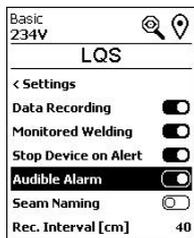
При включенной функции Audible Alarm (Звуковой аварийный сигнал), в случае превышения предельного значения подается звуковой аварийный сигнал. Чтобы выключить звуковой аварийный сигнал, выберите пункт меню Audible Alarm (Звуковой аварийный сигнал), нажав кнопку «Минус» (32), а затем нажмите кнопку «Подтвердить» (33). Если функция Stop Device on Alert (Выключение после аварийного предупреждения) не включена, можно установить отклонения предельных значений аварийных сигналов по отдельности.
