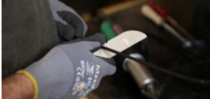
Удаление оксидного слоя со сварочного прутка
