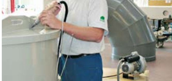
Вентилятор ROBUST подаёт воздух к WELDING PEN
