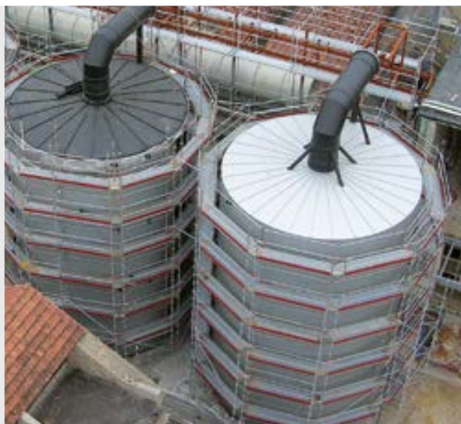
Система очистки воздуха, Испания. Материал ПЭНД
