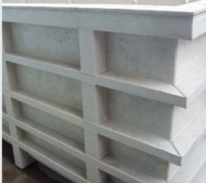
Гальваническая ванна, Турция. Материал ПП
