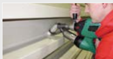
Облегчает сварку в труднодоступных местах: адаптер 45° для WELDPLAST S2 (принадлежность)
