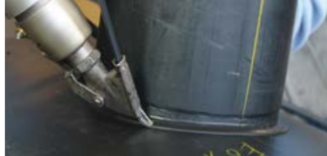
Сварка комбинированной насадкой
