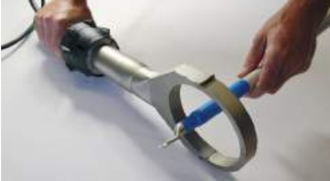
Процесс термоусадки при помощи аппарата ELECTRON ST
