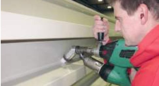
Угловая насадка 45° для WELDPLAST S2 облегчает сварку в труднодоступных местах (принадлежность).
