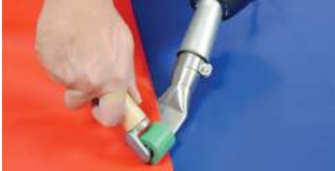
Сварка технических тканей ручным аппаратом TRIAC AT с цифровым управлением. Контроль температуры сварки, регулируемый расход воздуха
