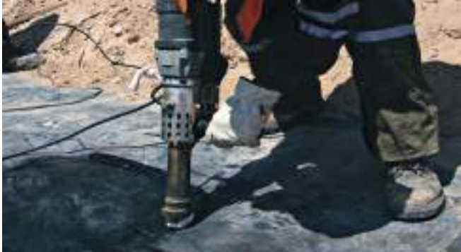
FUSION 3 C обеспечивает комфортную работу даже в неудобном месте
