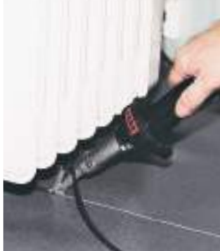
Маленький и лёгкий аппарат HOT JET S отлично подходит для сварки в узких и труднодоступных местах
