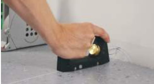
Новый «Groovy» идеально подходит для обработки швов и стыков напольных покрытий
