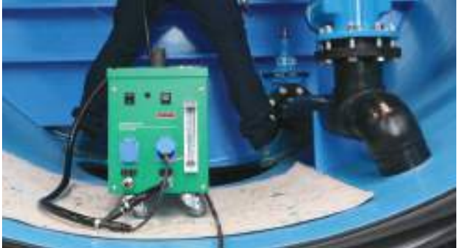
AIRSTREAM ST — тихий блок подачи воздуха
