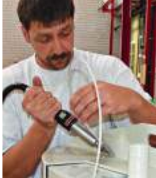
Сварка прутком с использованием компактного и легкого аппарата WELDING PEN R
