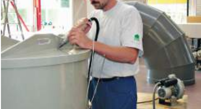
Вентилятор ROBUST подаёт воздух к WELDING PEN
